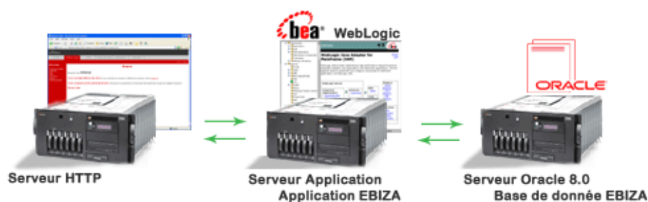
Schéma représentant l'organisation des différents logiciels et application en phase de production
